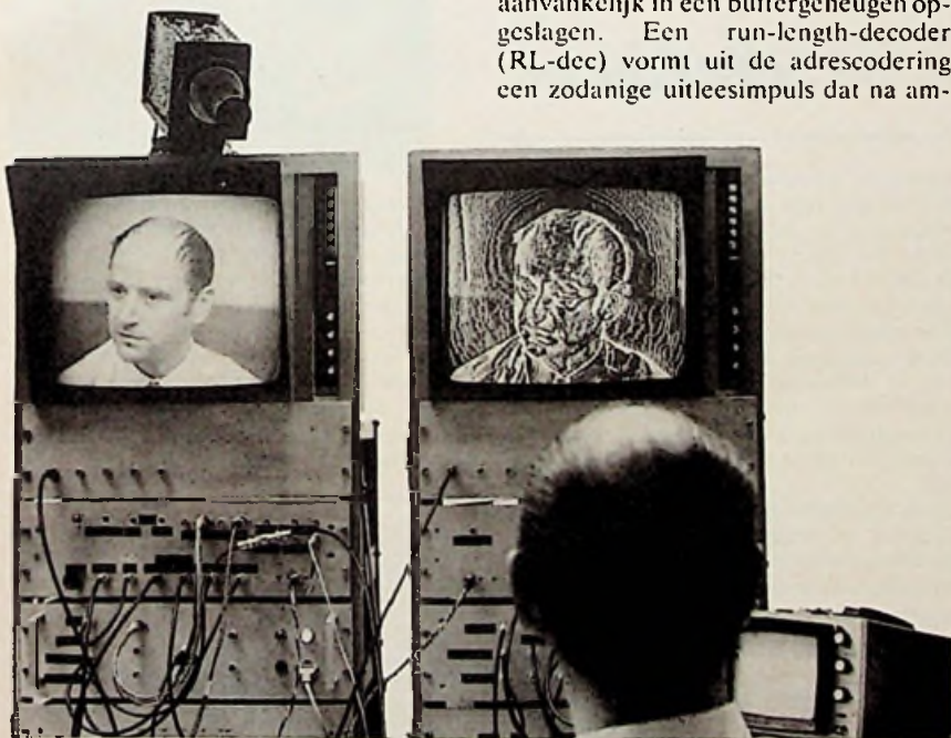
Afb. 2. Het door de TV-camera (links boven) opgenomen portret wordt door de adaptieve compressie-inrichting gecodeerd. Het relevantie-sigitaal op de rechter monitor geeft aan waar in het beeld relevante helderheidsverschillen optreden. Alleen de „belangrijkste” verschillen worden uitgezonden en in gecodeerde vorm overgebracht. De ontvangst-decoder reconstrueert uit deze „belangrijkste” signalen weer het volledige beeld (linker monitor). Bij deze codering wordt slechts ongeveer 1/5 de deel van de bij directe PCM-codering benodigde informatie overgebracht (compressie-factor K = 1:5 ).
